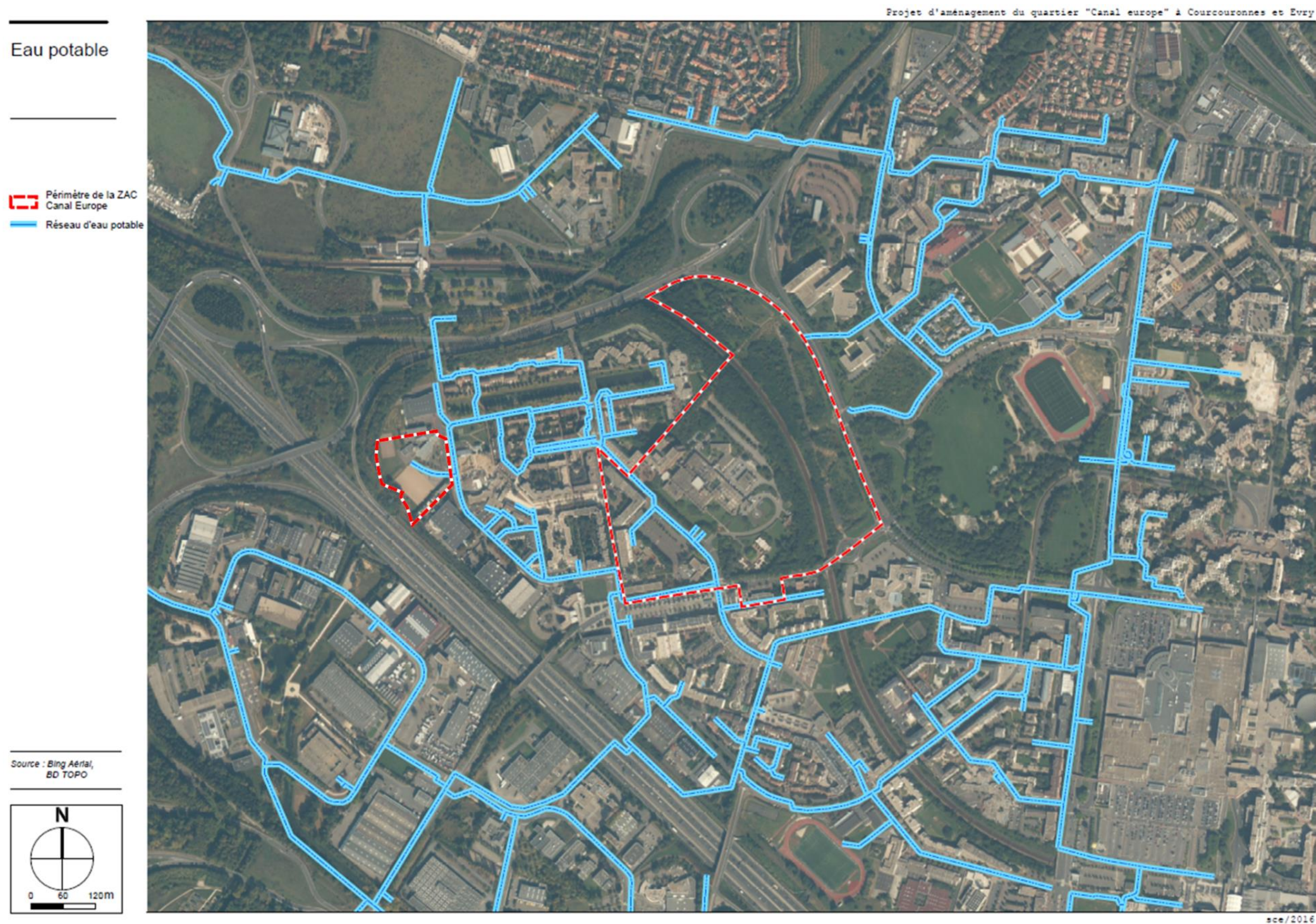
Figure 131 : Réseau d'eau potable
